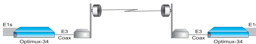
Верное подключение E1 через спутниковую линию
