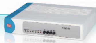
FOM-40 - это высокоскоростной синхронный оптоволоконный модем, работающий в полном или полудуплексном режиме по оптоволоконному кабелю. Возможен выбор одной из 12 скоростей передачи данных от 56 Кбит/с до 2.048 Мбит/с и дальность до 100 км. FOM-40 может работать по одномодовому или многомодовому волокну с использованием светодиодов с длиной волны 850 или 1310 нм, или лазерных диодов 1310 или 1550 нм.
