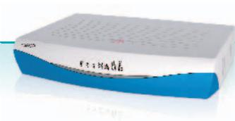
Оптоволоконный модем FOM-E1/T1 осуществляет преобразование электрических сигналов интерфейса E1/T1 в оптический сигнал. Преобразованный сигнал передается по оптоволоконному кабелю на расстояние до 144 км.
