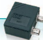
Преобразователь интерфейсов коакс/витая пара (балун) BE-1 позволяет подключать любое оборудование E1, оснащенное несимметричным интерфейсом для коаксиального кабеля, к витой медной паре вместо более дорогостоящего коаксиального кабеля. Конвертер BE-1 позволяет подключать аппаратуру E1 или ISDN, оснащенную симметричным интерфейсом для витой пары, к существующим коаксиальным кабелям.
