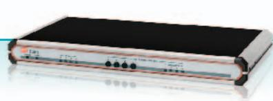
Цифровые устройства разделения каналов RSD допускают возможность подключения любой комбинации, включающей до восьми модемов (DCE) и/или терминалов DTEs для совместного использования ресурсов: модема, мультиплексора или порта компьютера. Устройства RSD-1 и RSD-10 полностью прозрачны для системы и для данных и работают с синхронным или асинхронным оборудованием. Для синхронизации служит внутренний тактовый генератор или используются внешние синхроимпульсы от главного канала или от подканала 1.
