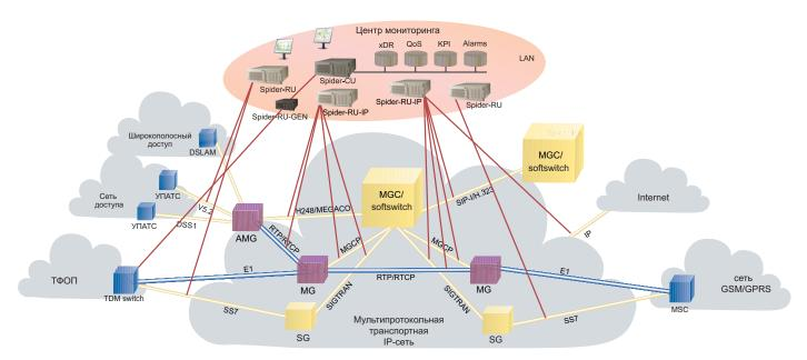
Система сетевого мониторинга СПАЙДЕР обеспечивает распределенный сбор и централизованную обработку информации на сетях связи любого масштаба, построенных на основе различных телекоммуникационных технологий.
