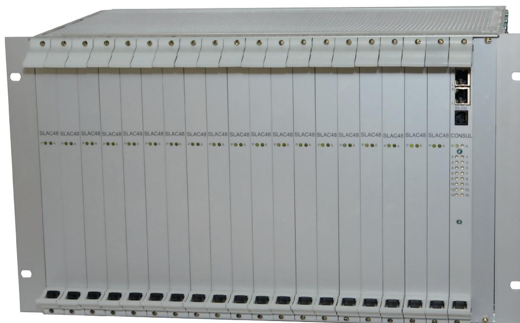
Абонентский концентратор служит для подключения телефонов абонентов по аналоговым двухпроводным линиям, а также для подключения абонентов к сети передачи данных по технологии VDSL2.
