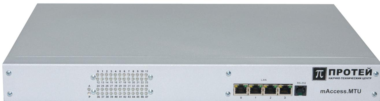
Абонентский шлюз малой емкости mAccess.MTU выполнен в виде компактного модуля 1U 19" (24 или 48 АЛ в устройстве)
